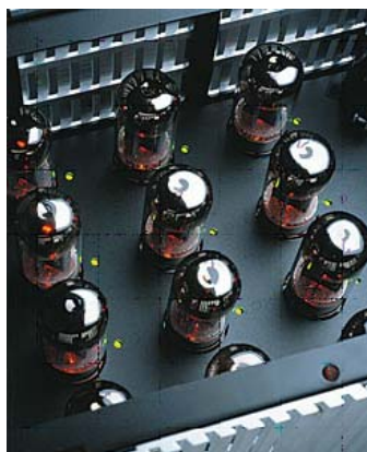
Az S-400-as fedele alatt: A csövek mellett lévő zöld világító diódák állapotjelzők és villogásukkal jelzik, ha a készülék éppen a fűtőfeszültségét állítja.
