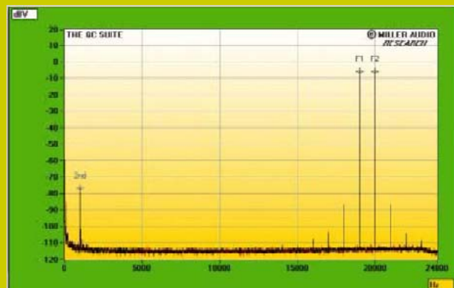
6.ábra: A VTL-6.5 nagyfrekvenciás intermodulációs spektruma, DC-24 kHz, 19+20 kHz 1 V csúcshintű, 8 k ohmon (lineáris frekvencia skála).
